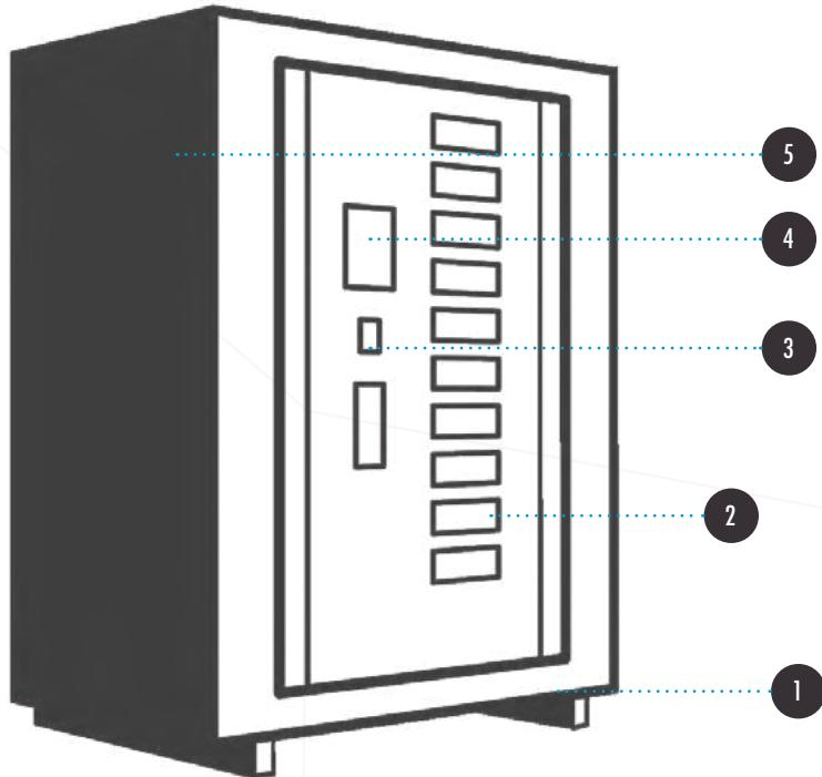
DYNABOX è composto da un **tamburo rotante** (1) sostenuto da una **struttura robusta** esterna in acciaio galvanizzato 8/10 (5), protetta da una verniciatura a polveri epossidiche.
